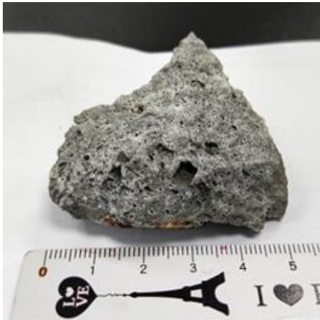
圖 11：灰白色有孔洞的矽化安山岩 肉眼可見孔洞內有些許礦物結晶。
