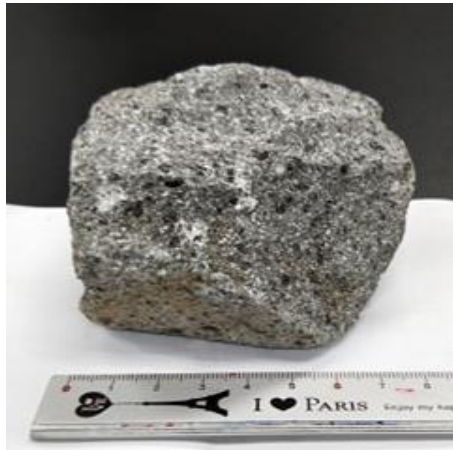
圖 7：未換質的安山岩 肉眼可見短柱狀及片狀黑色礦物 (礦石來源：新北市基隆山)
